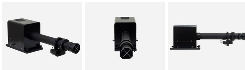
投光器は、反射器の反射面にムラのない均一な光を照射する装置です。専用電球 (12V4A GB-V) を使用し、f=500mmのコリメータレンズによって直径260mmの照射面を作ります。
